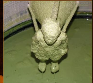
Herstellung der Keramikschale durch Auftragen der einzelnen Keramikschichten
